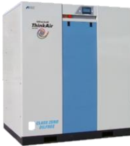
SLP-22EF (30馬力; 6模組) 2,700L/min@8bar 95.5cm 137.0cm x 155.5cm
